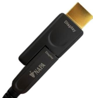
4. コネクター間に隙間が無いよう、しっかりと microHDMI コネクターに HDMI コネクターを取付ける
