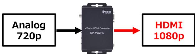
A/Dのフォーマット変換だけではなく、**スケーラー機能**を搭載しています。表示機に最適な解像度・アスペクト比で出力する事ができます。
